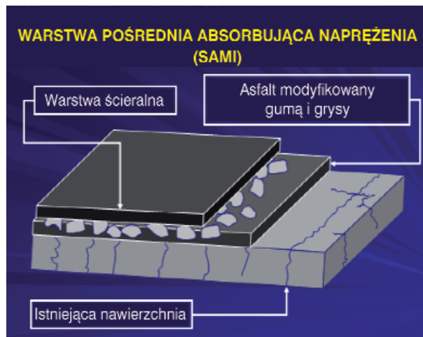
Typowy przekrój nawierzchni z warstwą SAMI
